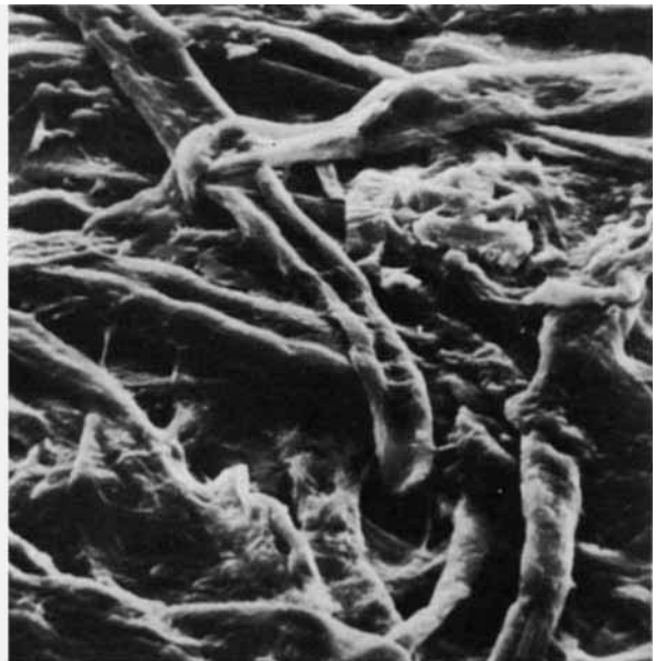
Abb. 1. Oberfläche eines Schreibmaschinenpapiers (Stereoscan-Aufnahme). Links: Vergrößerung 100:1, rechts: 500:1.
